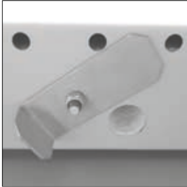
Zuluftklappe geöffnet Bild 7
